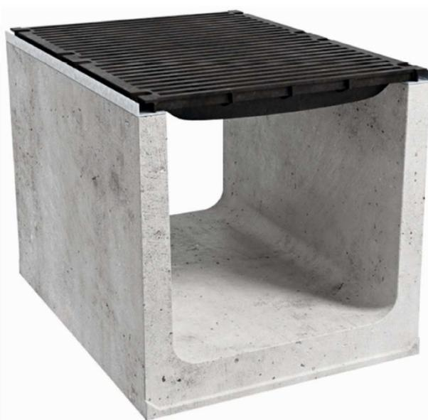
**Il profilo di protezione** ad L è realizzato in acciaio **S235 JR** con trattamento superficiale di zincatura a caldo, provvisto di inserti filettati M12 per il fissaggio della griglia in ghisa sferoidale F900.
