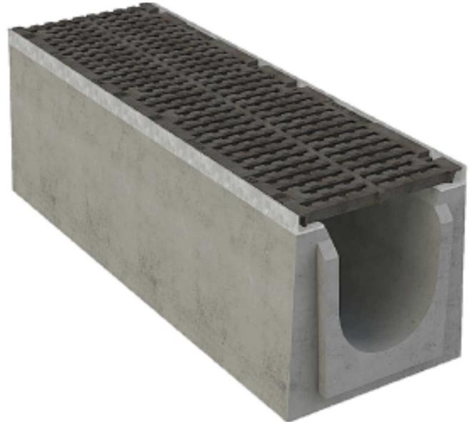
**Il profilo di protezione** ad L è realizzato in acciaio **S275 JR** con trattamento superficiale di zincatura a caldo, provvisto di inserti filettati M12 per il fissaggio in 4 punti della griglia in ghisa sferoidale **E600**. A richiesta è disponibile il profilo opzionale in ghisa sferoidale.
