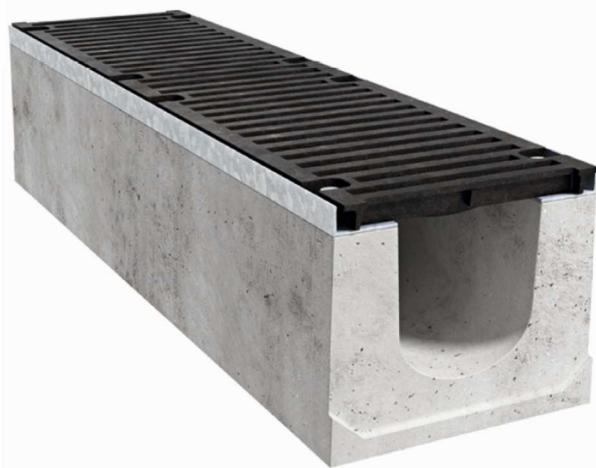
**Il profilo di protezione** ad L è realizzato in acciaio **S235 JR** con trattamento superficiale di zincatura a caldo, provvisto di inserti filettati M12 per il fissaggio della griglia in ghisa sferoidale F900.
