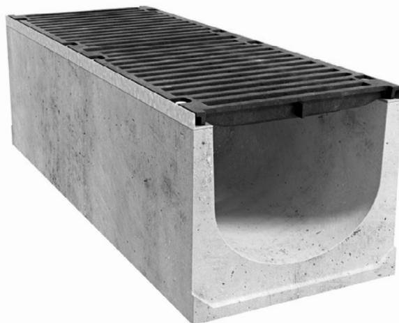
**Il profilo di protezione** ad L è realizzato in acciaio **S235 JR** con trattamento superficiale di zincatura a caldo, provvisto di inserti filettati M10 per il fissaggio delle griglie in ghisa sferoidale D400.
