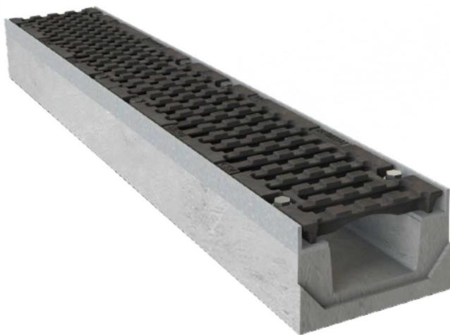
**Il profilo di protezione** ad L è realizzato in acciaio **S275 JR** con trattamento superficiale di zincatura, provvisto di inserti filettati M10 per il fissaggio in 4 punti delle griglie in ghisa sferoidale in classe di carico **D400**.
